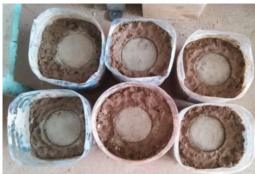
Рисунок 1. – Опытные фрагменты грунта с армодренирующими элементами внутри
