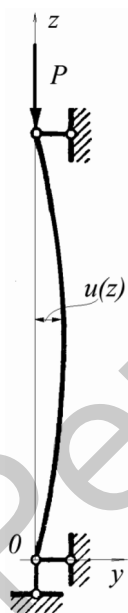
Рис. 2. Потеря устойчивости стержня при двух закрепленных концах
