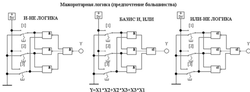
Рис. 12.3. Комбинационное логическое устройство для реализации мажоритарной логики в различных базисах (файл **kly\_maj.ewb**)
