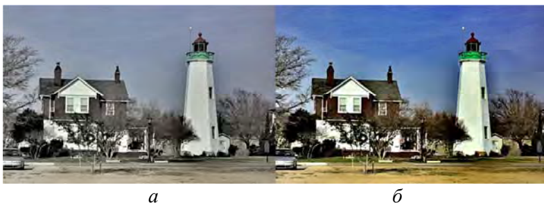
Рис. 10.18. Пример применения алгоритма Multi-Scale Retinex для \sigma = 7, 480, 4800 ( a ), плюс линейное растяжение контраста ( б )
