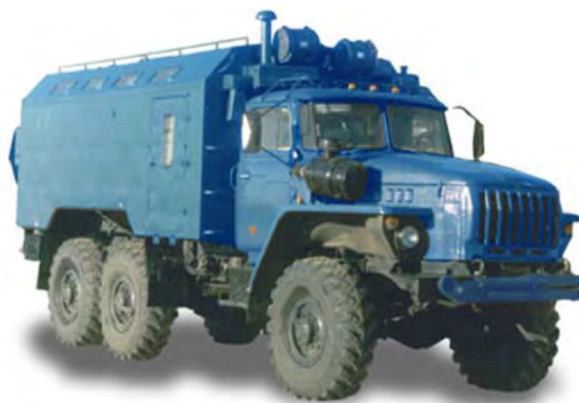
Рис. П5.3. Мастерская ремонтно-механическая МРМ-М3.1
