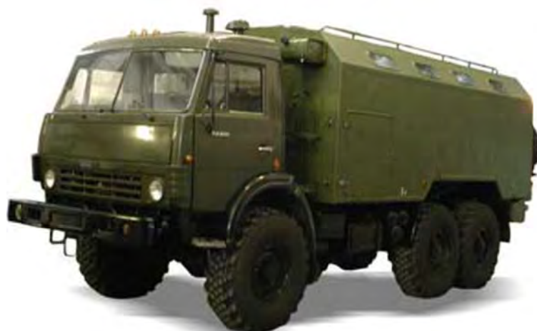
Рис. П5.6. Мастерская заряда и ремонта аккумуляторов МЗА
