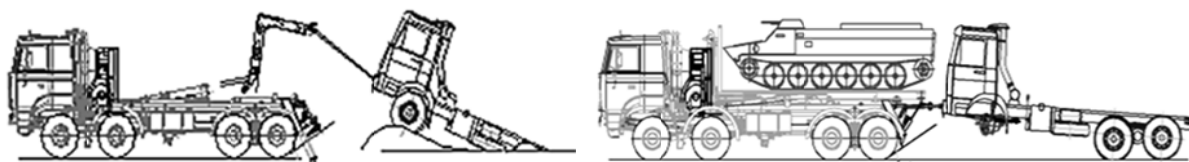
Рис. П13.2. Эвакуационная машина на базе МЗКТ-73011, оборудованная МПР-3 и устройством для транспортирования поврежденной техники полуподъемом
