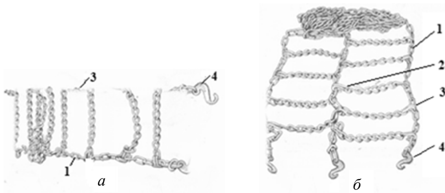
Рис. 3.8. Цепи противоскольжения: а – для одинарных колес; б – для сдвоенных колес; 1 – продольная цепь; 2 – поперечная цепь; 3 – соединительное звено; 4 – замок
