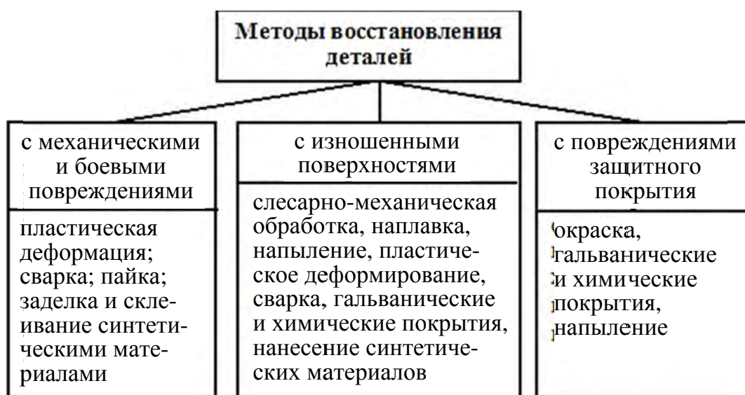
Рис. 4.2. Методы восстановления деталей
