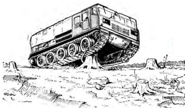
Рис. 3.34. Самовытаскивание объекта, застрявшего на пне с помощью буксирного троса
