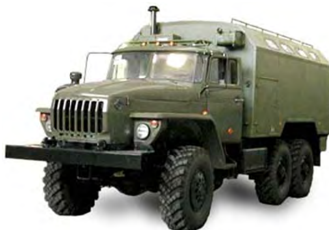
Рис. П5.7. Мастерская сварочных работ МСР
