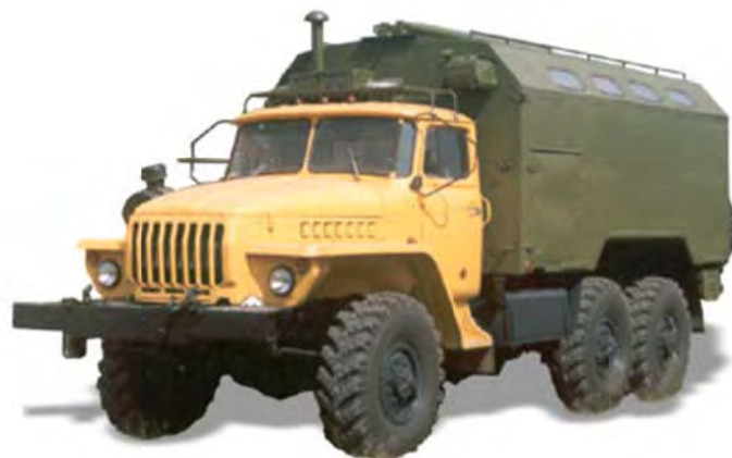
Рис. П5.4. Мастерская ремонта электрооборудования МРЭ-АМ1
