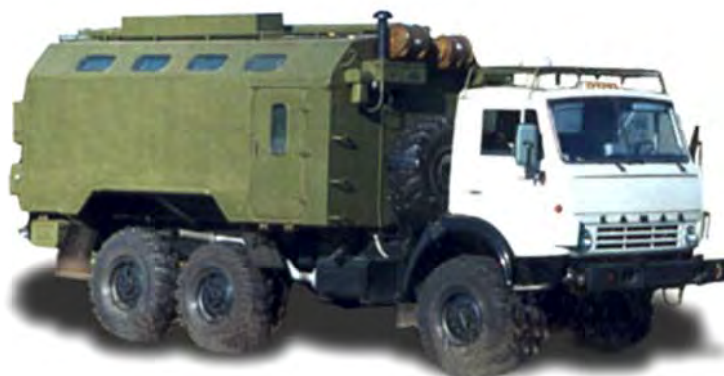
Рис. П5.2. Мастерская ремонтно-слесарная MPC-АМР
