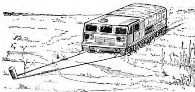
Рис. 3.33. Самовытаскивание с использованием тросов, закрепленных за гусеницы
