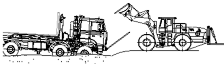
Рис. П13.5. Эвакуационная машина на базе автопогрузчика с адаптером МоА3-40484-025, дооборудованного гидравлической лебедкой и устройством для транспортирования поврежденной техники полуподъемом
