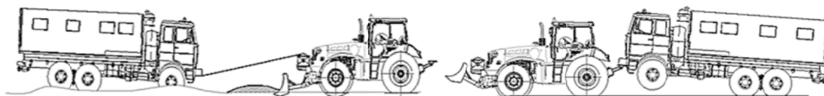
Рис. П13.4. Эвакуационная машина на базе колесного трактора «Беларус 3023» с электромеханической трансмиссией, дооборудованного земляным отвалом, гидравлической лебедкой и устройством для транспортирования поврежденной техники полуподъемом
