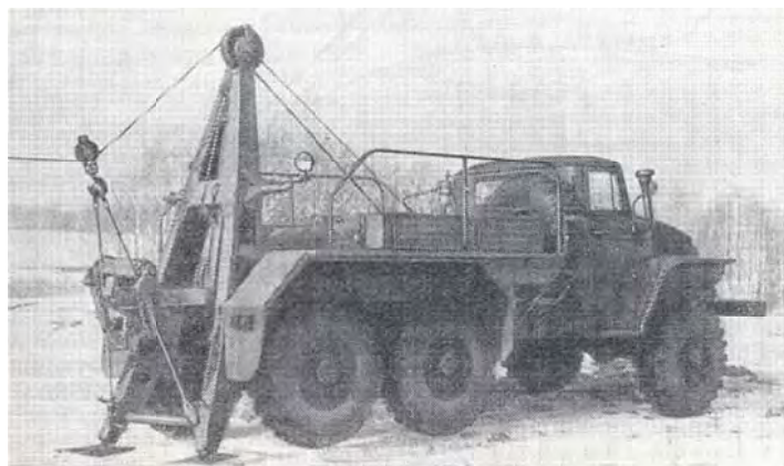
Рис. 3.36. Установка понизителя троса лебедки
