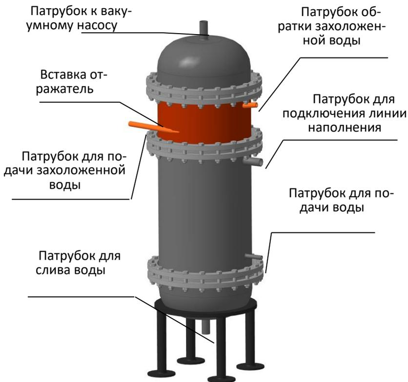
Рисунок 1 – Вакуумная ловушка
