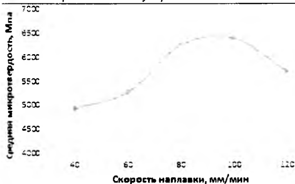
Рисунок 3 – Зависимость средней микротвердости в валике из сплава ПГ-12Н-01 от скорости наплавки
