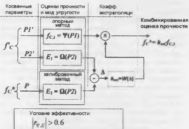
Рисунок 5 – Алгоритм экстраполирующего (мультипликативного) комбинированного метода испытаний
