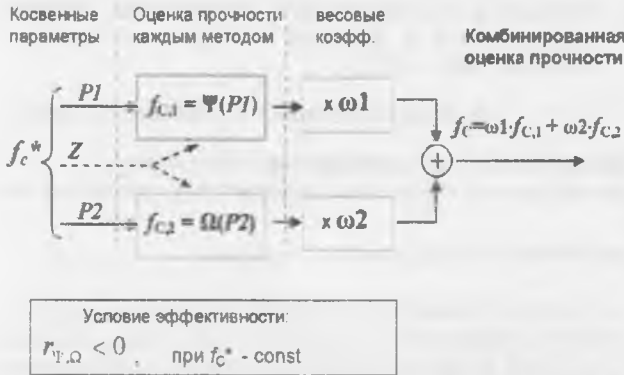
Рисунок 1 – Алгоритм аддитивного объединения оценок прочности 2-х методов испытаний
