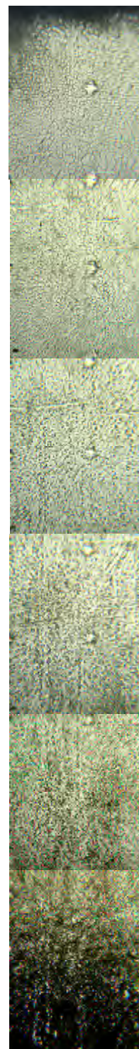
Рис. 1. Структура модифицированного слоя образцов 1 партии, \times 150
