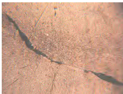
Рис. 7. Структурные изменения в области распространения трещины контактной усталости в образцах 1 партии после 17200 циклов нагружения контактным напряжением 1300 МПа ( \times 250 )
