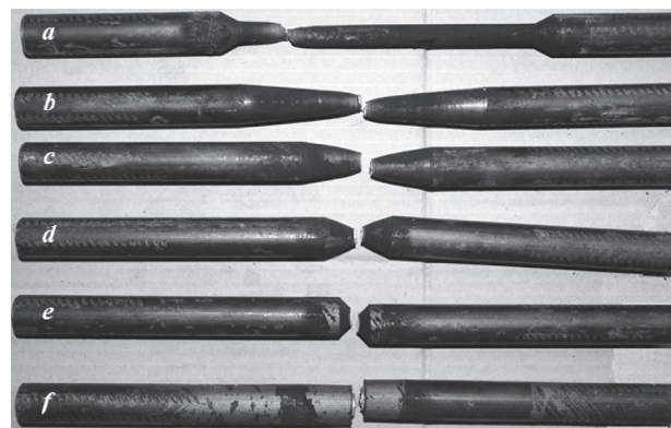
Рисунок 3 — Вид образцов 1-й серии после испытания (скорость подвижной траверсы 0,8–1,6 мм/с)
