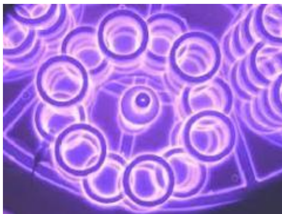
Рисунок 1 – Ионное азотирование колец
