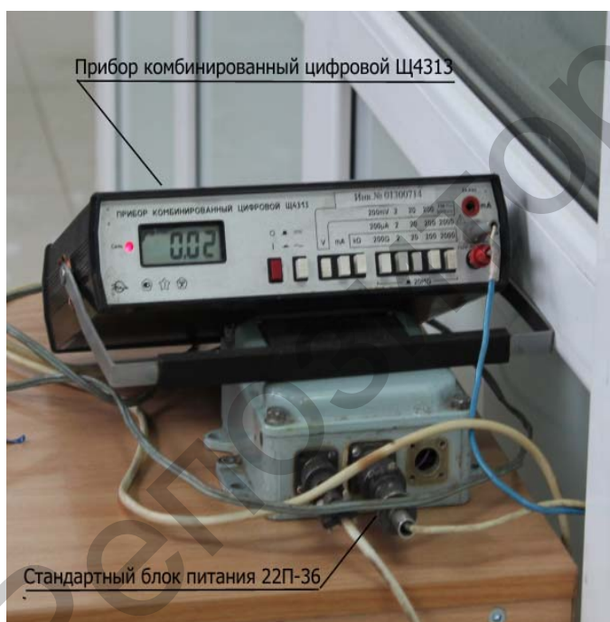
Рисунок 3 – Фотография прибора комбинированного цифрового Щ4313 и стандартного блока питания 22П-36
