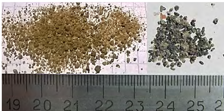
Рис. 1. Внешний вид частиц наполнителей: слева – кварцевый песок; справа – гранитный отсев
