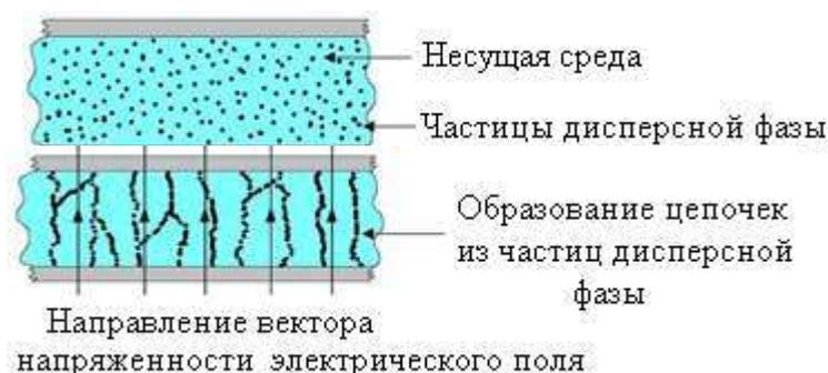
Рисунок 1 – Структурирование дисперсной фазы в электрическом поле
