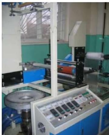
Рисунок 1 – Экструдер
