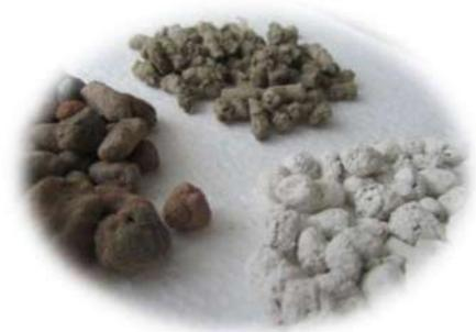
Рисунок 1 – Внешний вид гранул заполнителя на основе СКОПа
