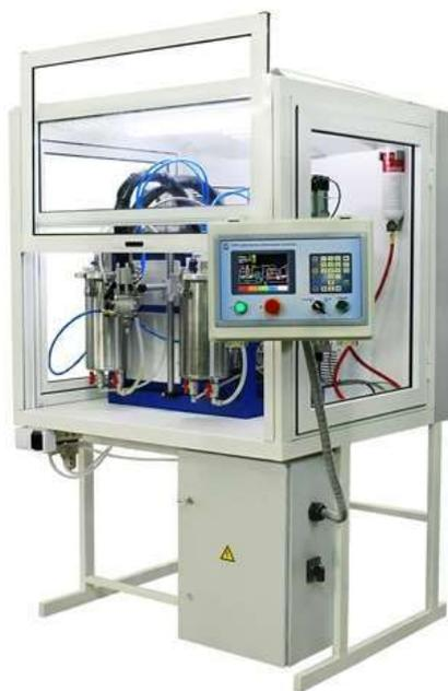
Рисунок 1 – Оборудование для производства вспененных эпоксидных компаундов.
