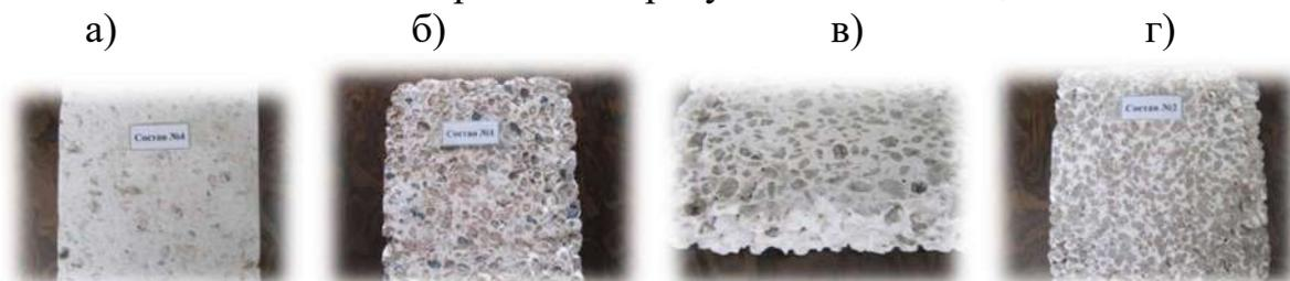
Рисунок 2 – Внешний вид образцов теплоизоляционных материалов на основе негранулированного СКОПа (а) и гранул из СКОПа (б, в, г)
