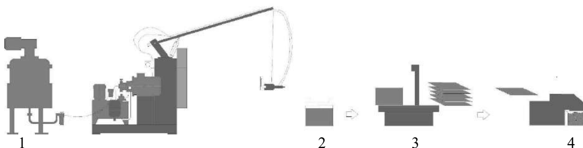
Рисунок 1 - Состав комплекса оборудования для производства сорбента Пенопурм®
