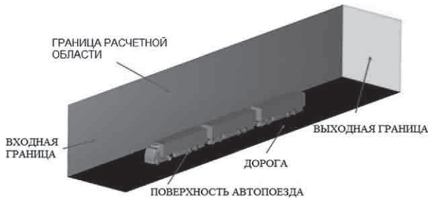
Рисунок 4 — Расчетная область с моделью автопоезда
