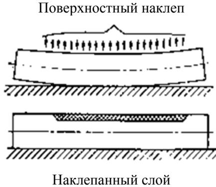
Рис. 4.2. Схема правки местным поверхностным наклепом
