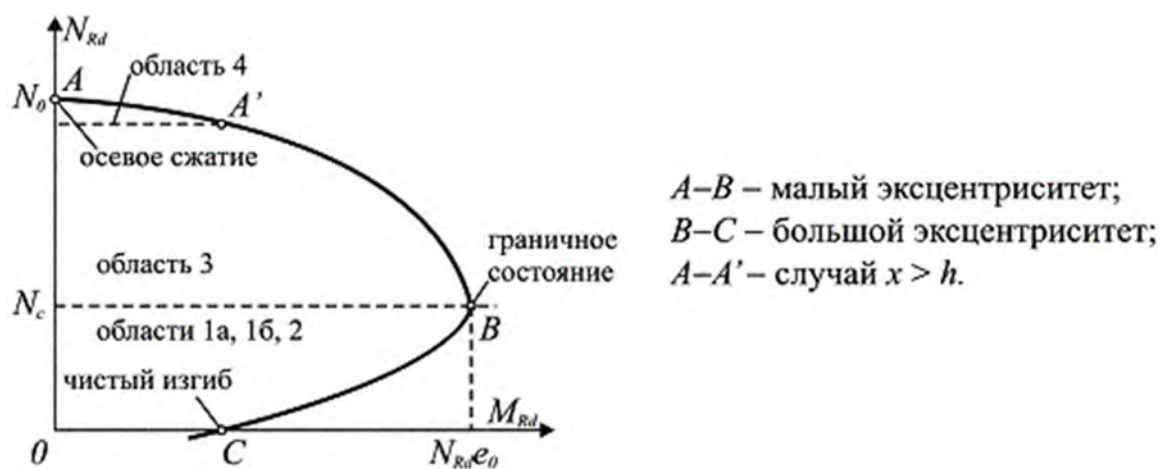
Рис. 1.30. Схематичная кривая взаимодействия « N_{Rd}-M_{Rd} » для внецентренно сжатого сечения
