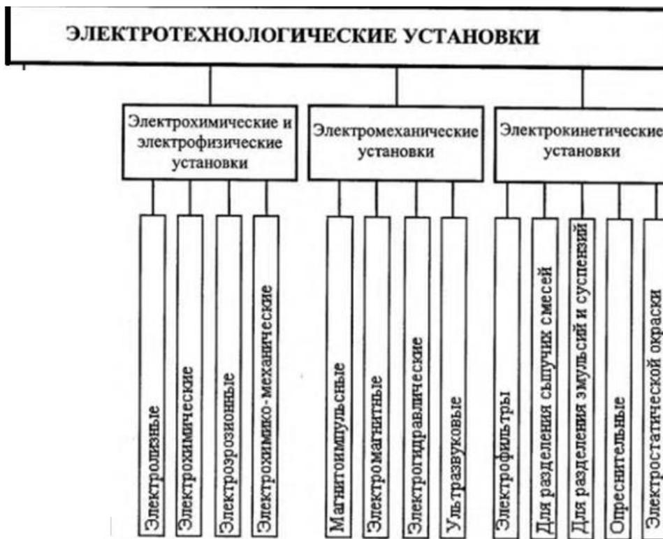
Рисунок 1 – Классификация электротехнологических установок
