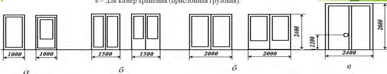
а – глухая и остекленная с притвором в четверть (однопольная); б – глухая и остекленная с притвором в четверть (двупольная); в – для камер хранения (прислонная грузовая).
