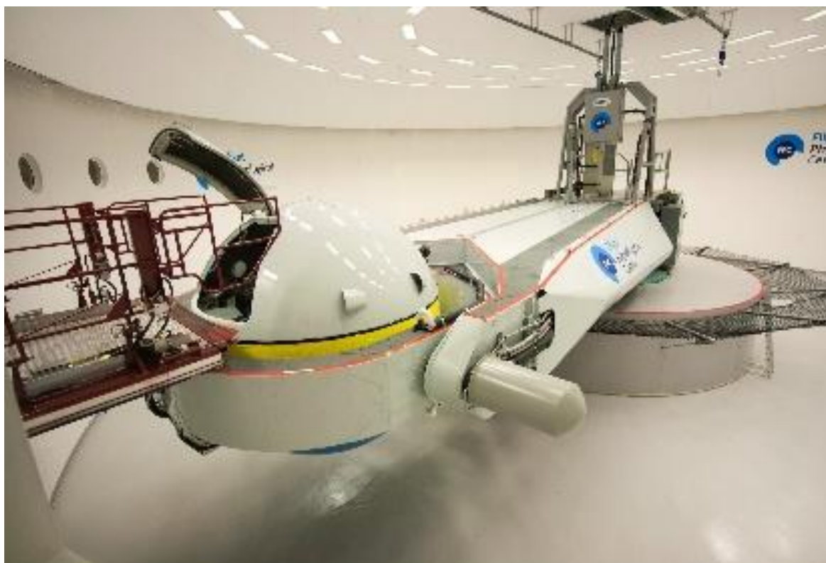
Рисунок 1. Центрифуга для подготовки космонавтов в г. Линчёпинг, Швеция.
