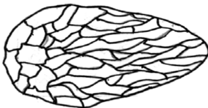
Рис. 3.4. Кристаллическое строение сварочной ванны при мгновенном прекращении дуговой сварки
