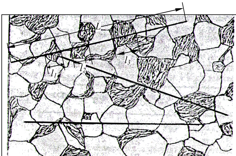
Рис. 2.14. Схема определения фазового состава стали линейным методом Розиваля
