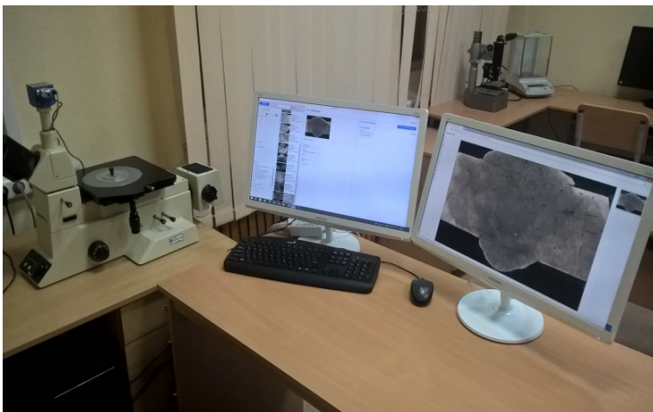
Рис. 2.15. Металлографический комплекс на базе микроскопа МИИТ для комплексных исследований микроструктуры металлов и сплавов
