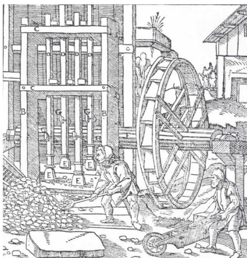
Установка для толчения руды с водяным приводом
