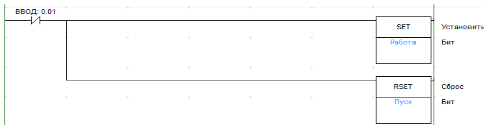
Рисунок 3. Запуск программы при включении входного контакта.
