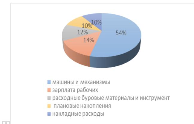
Рис. 3. Осредненная структура затрат на изготовление кубического метра свай (без бетона и арматуры)
