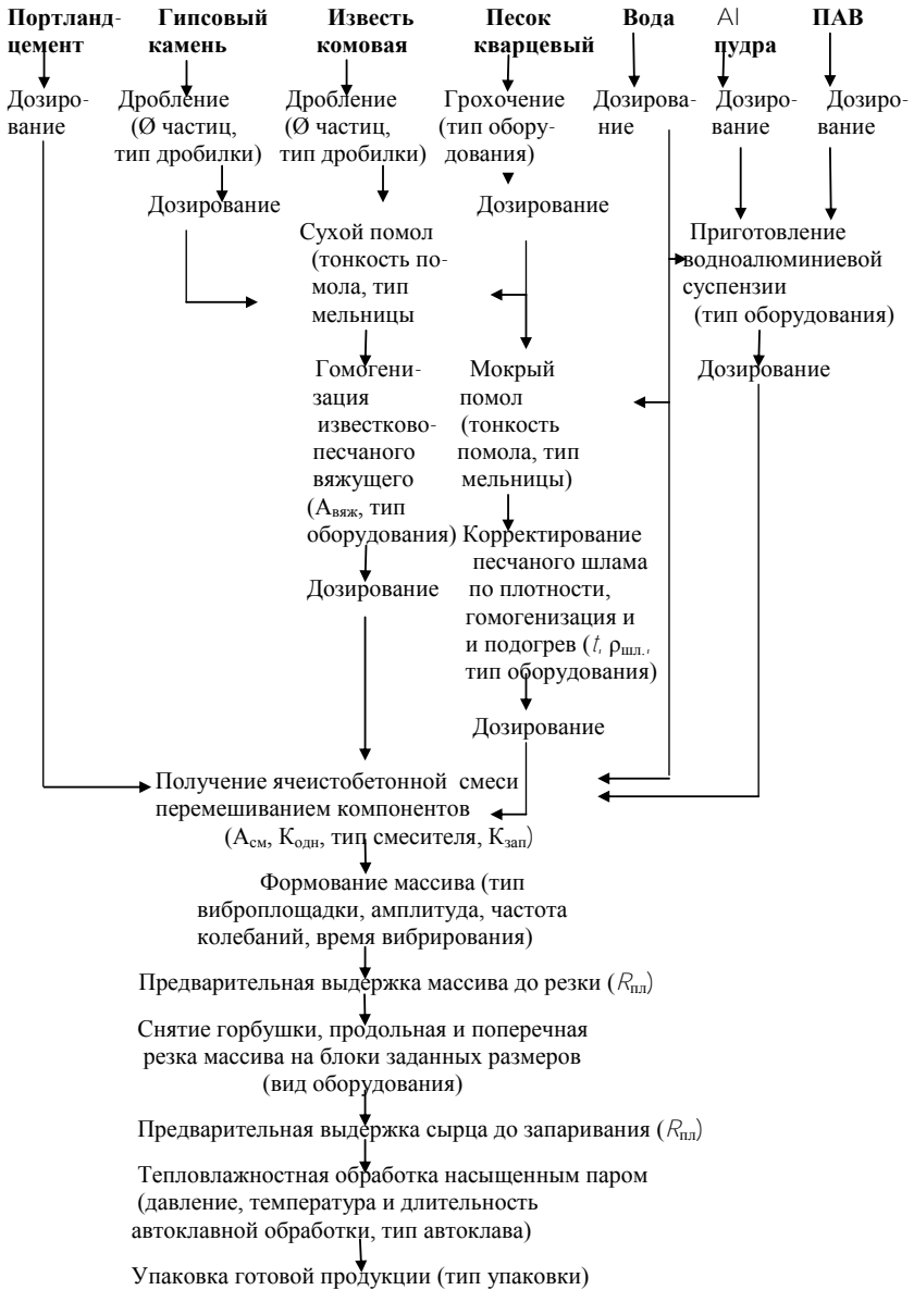
Рис. 2. Пример принципиальной технологической схемы производства стеновых блоков на основе известково-кремнеземистых вяжущих автоклавного твердения
