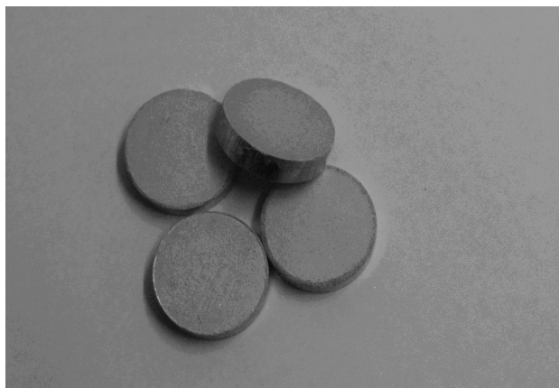
Рисунок 3 – Общий вид брикетов модификатора раскислителя, содержащего исследуемые ультрадисперсные соединения титана и бора
