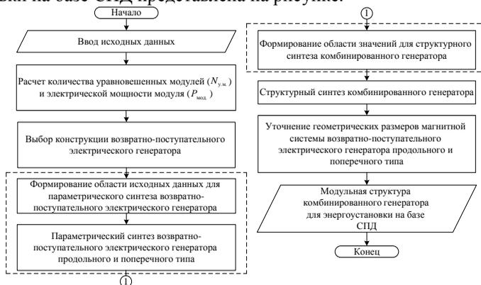
Блок-схема алгоритма методики структурно-параметрического синтеза
