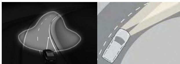
Рис. 6.2. Схема изменения направления светового пучка активных фар при повороте
