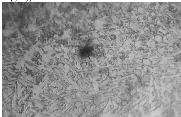
Рисунок 2 - Структура исследованного чугуна СЧ20 в зоне оплавления, х990
