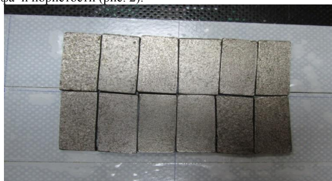
Рисунок 2 – Топография поверхности стальных образцов после их обработки а различных режимах ЭИЛ с УЗВ
