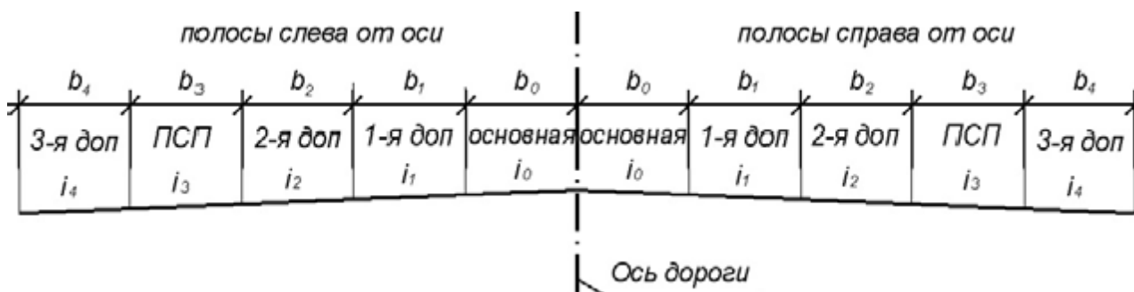
Рис. 9.2. Проезжая часть дороги
