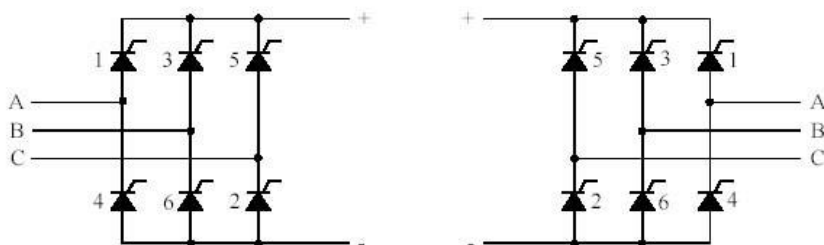
Рис. 1.44. Виды входных зажимов трехфазного моста
