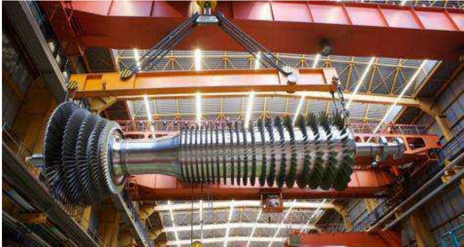
Рисунок 4. Испытуемый ротор подвешен на траверсе
