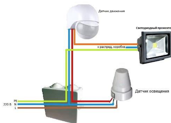
Рисунок 4. Схема подключения датчика движения и датчика освещения
