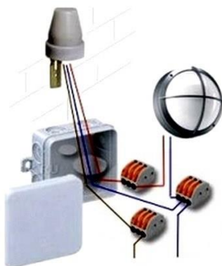
Рисунок 2. Схема подключения датчика
