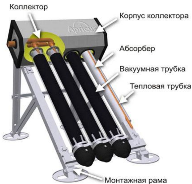
Рисунок 2. Вакуумный солнечный коллектор с разрезами.
