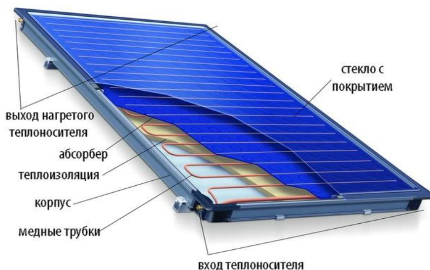
Рисунок 1. Плоский коллектор с разрезом.
