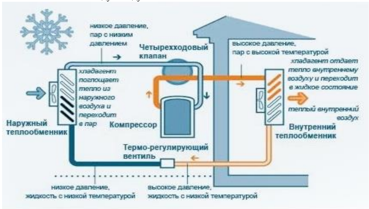
Рисунок 2. Устройство и принцип работы теплового насоса «Воздух-воздух».
