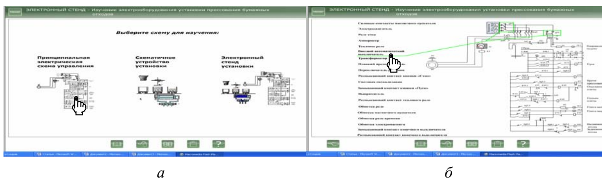
Рисунок 2 – Скриншот окна «Выберите схему для изучения» (а) и скриншот окна с обучающей технологией состава принципиальной электрической схемы (б)
