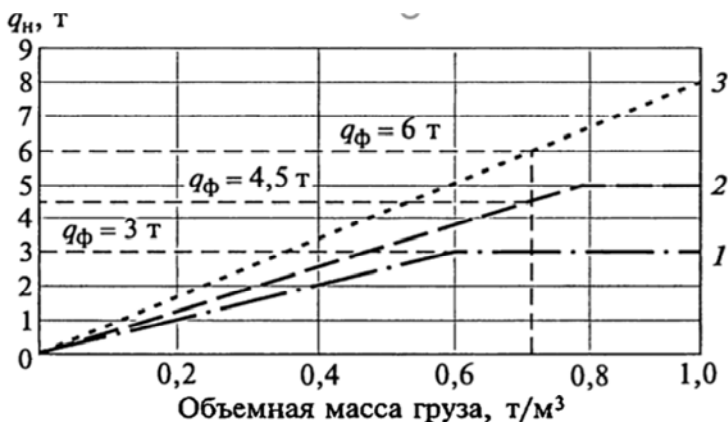
Рис. 7.1. График использования ПС разной грузовместимости: 1) q_{\text{н}} = 3 \text{ т} , q_{\text{ф}} = 3 \text{ т} ; 2) q_{\text{н}} = 5 \text{ т} , q_{\text{ф}} = 4,5 \text{ т} ; 3) q_{\text{н}} = 8 \text{ т} , q_{\text{ф}} = 6 \text{ т}
