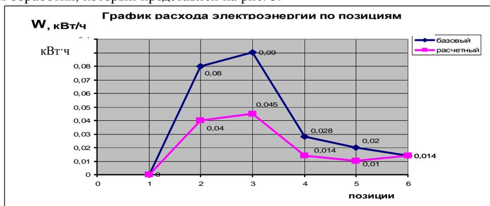
Рисунок 3 – Зависимость расхода электроэнергии по позициям обработки(крышка гидроусилителя ОАО «АГУ»; токарный полуавтомат).
