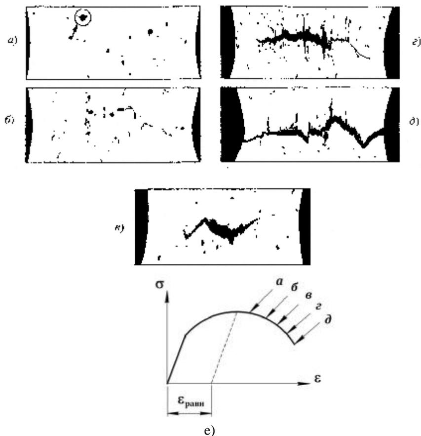
Рис. 1. – Накопление повреждений и стадии роста трещин (а, б, в, г, д) на ниспадающем участке диаграммы растяжения  $\sigma$ - $\epsilon$ (e).
