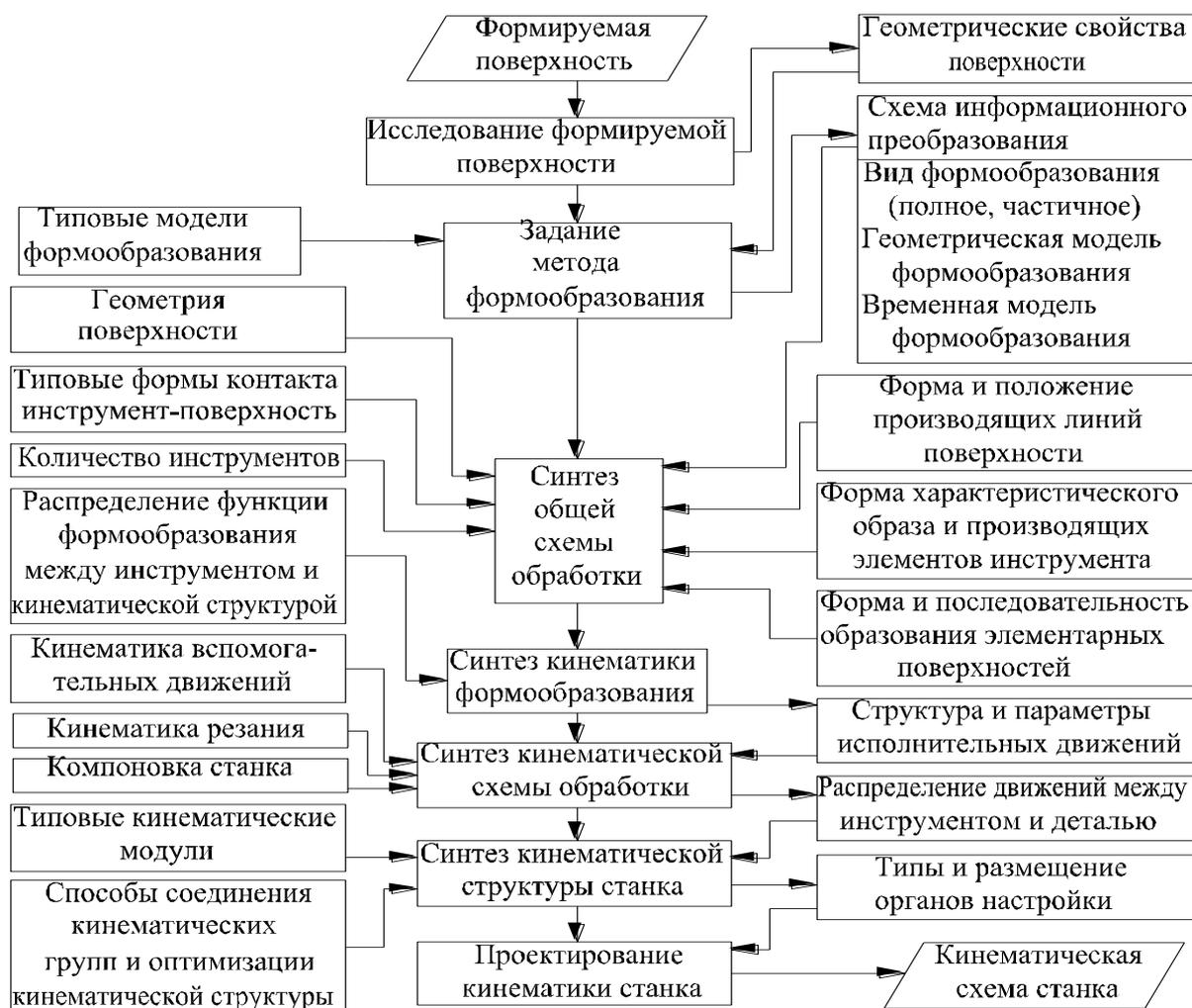
Рис. 2. Этапы синтеза кинематической схемы станка
