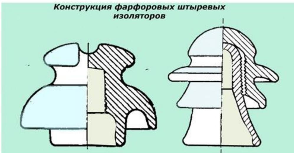
Рисунок 1. Конструкция фарфоровых штыревых изоляторов
