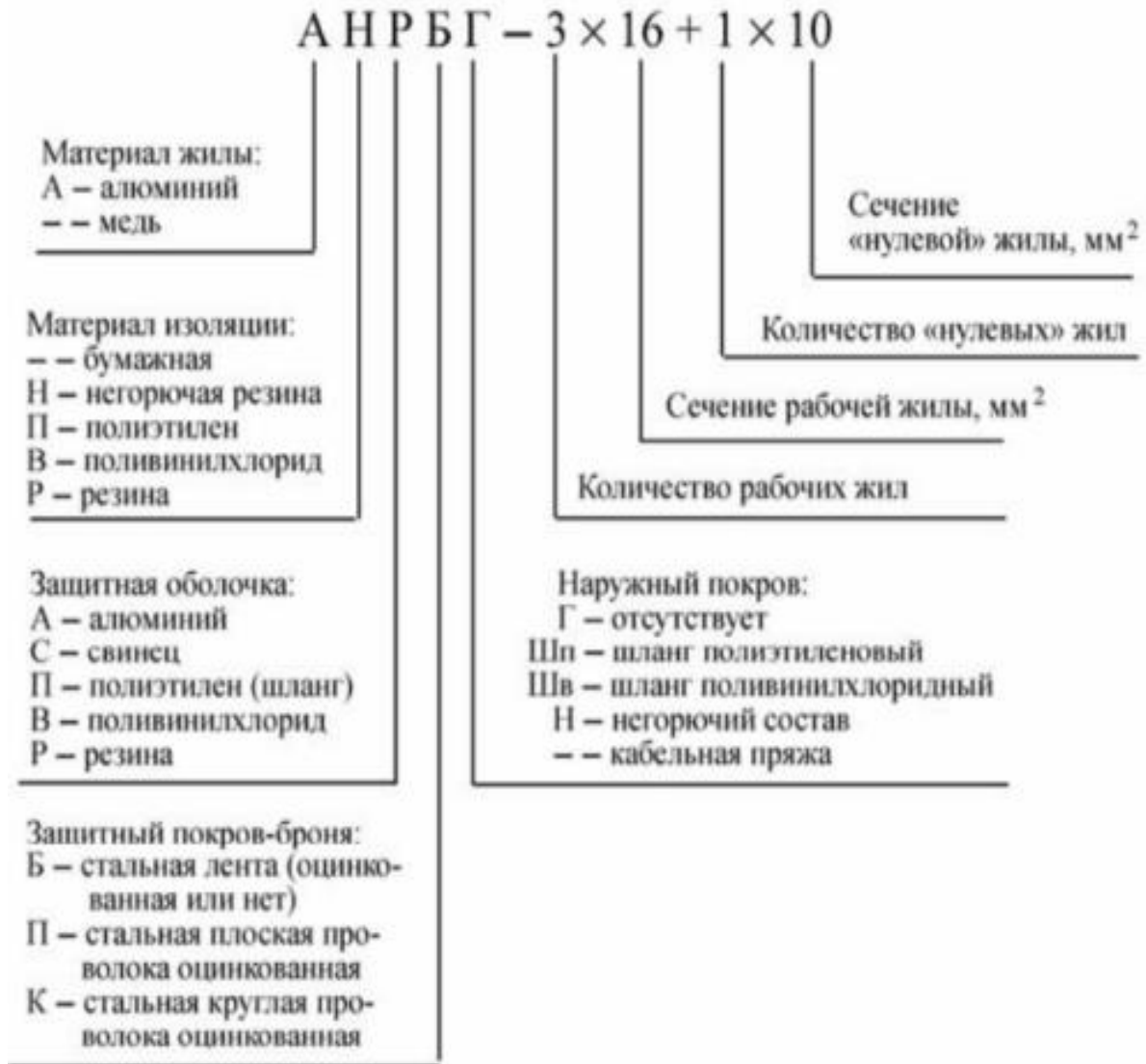
Рисунок 1 Маркировка силовых кабелей
