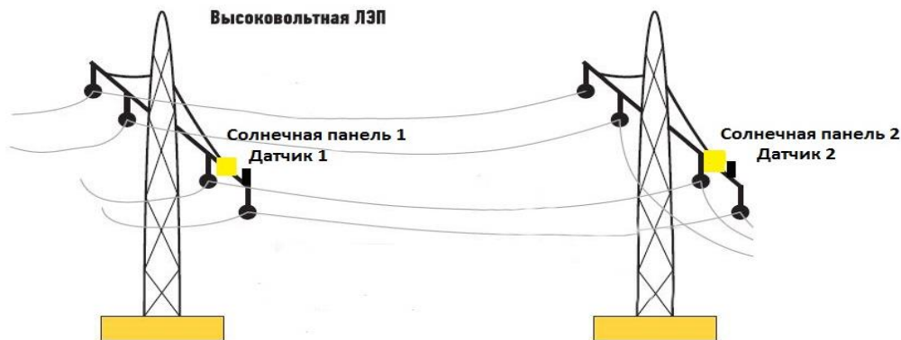
Рисунок 1 – Размещение измерительных датчиков и солнечных панелей на опоре ЛЭП
