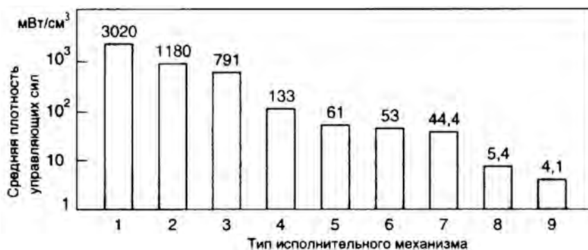
Рис. 3.15. Средняя плотность управляющих сил некоторых исполнительных механизмов: 1 – гидроцилиндр; 2 – пневмоцилиндр; 3 – электродвигатель постоянного тока; 4 – ультразвуковой двигатель; 5 – пьезоэлектрический привод; 6 – проволока с памятью; 7 – клапанный соленоид; 8 – магнитоstrictionный привод; 9 – соленоид, включенный в течение 5 % времени
