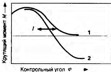
Рис. 3.7. Характеристики электромагнитных поворотных приводов: 1 – поворотный привод с одноходовой обмоткой; 2 – двигатель с большим пусковым моментом
