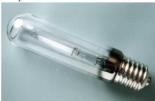
цилиндрическую или эллиптическую форму и оснащена резьбовым цоколем. При работе лампы дуговой разряд в горелке осуществляется в парах ртути и натрия, что способствует его стабилизации.
