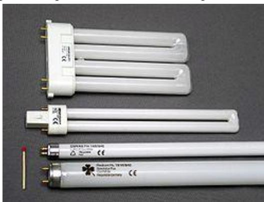
Люминесцентные лампы основаны на двойном преобразовании энергии: превращении электрической энергии в ультрафиолетовое излучение паров ртути (электр люминесценция) и ультрафиолетового излучения в видимое при поглощении люминофором (фотолюминесценция).
