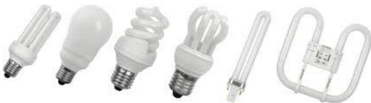
Компактные люминесцентные лампы типа КЛС предназначены для непосредственной замены малоэффективных ламп накаливания и снабжены стандартными винтовыми цоколями E14, E27, имеют мощность от 5 до 57 Вт, светоотдачу до 75 лм/Вт и срок службы от 6 до 12 тыс. ч.
