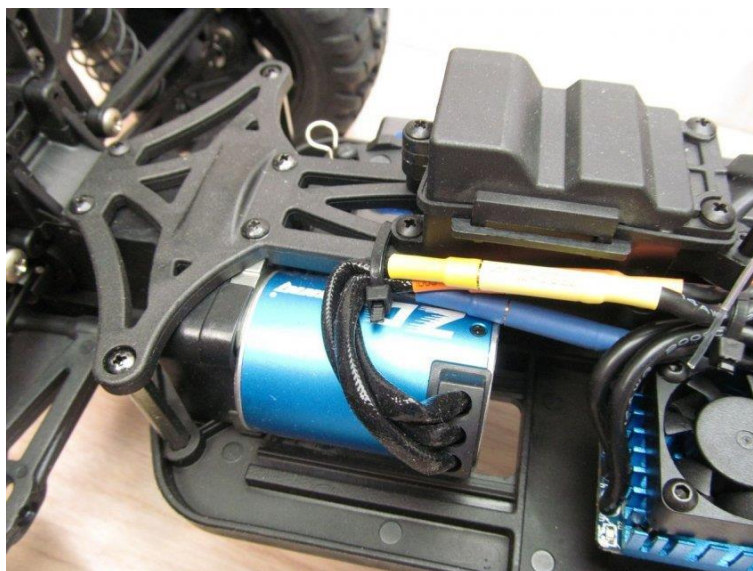
Рисунок 9. Шасси масштабной радиоуправляемой модели автомобиля с бесколлекторным двигателем
