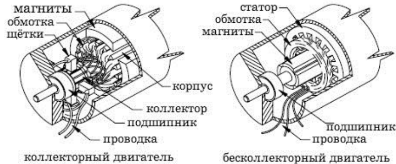
Рисунок 3 – Конструктивные отличия бесколлекторного двигателя и коллекторного двигателя
