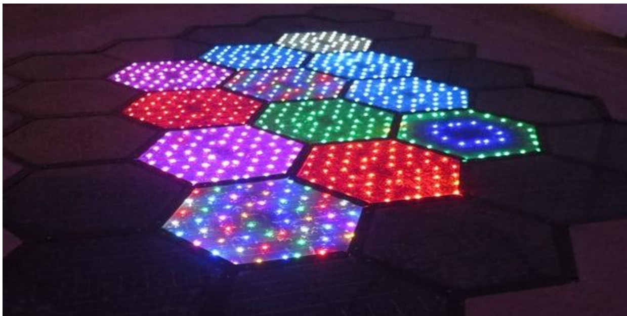
Рисунок 4. LED-подсветка в SolarRoadways
